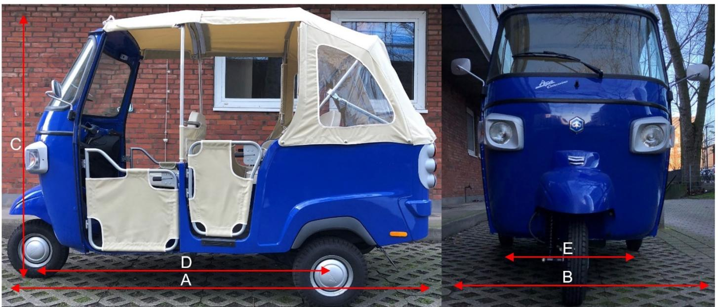
Abbildung 4: Piaggio Ape Calessino Abmessungen
