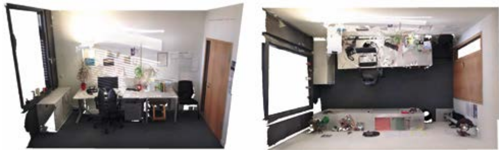
Abbildung 4.11: Übersicht des Raums: Vorderansicht, Draufsicht (Projektpunktwolke des registrierten Gesamtscans).
