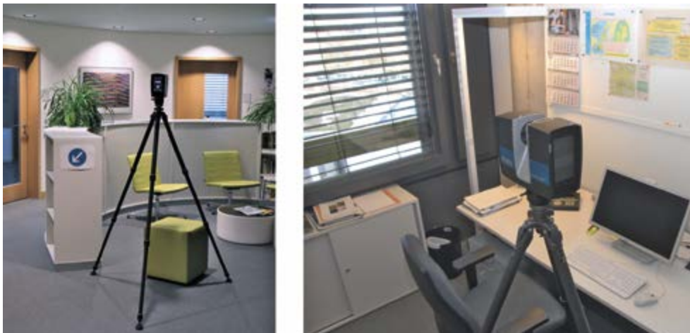
Abbildung 4.2: Messaufbau – FARO Focus S 350 Laserscanner auf Stativ (Bildquelle rechtes Foto: Thorsten Walter, BSW).
