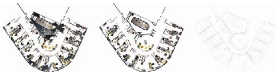
Abbildung 5.1: Herausarbeitung der Konturen in Autodesk Revit mithilfe von FARO As-Built (links: Schnitt bis Bodenebene, Mitte: Schnitt 10 cm über Bodenebene, rechts: Kontur [blass]).
