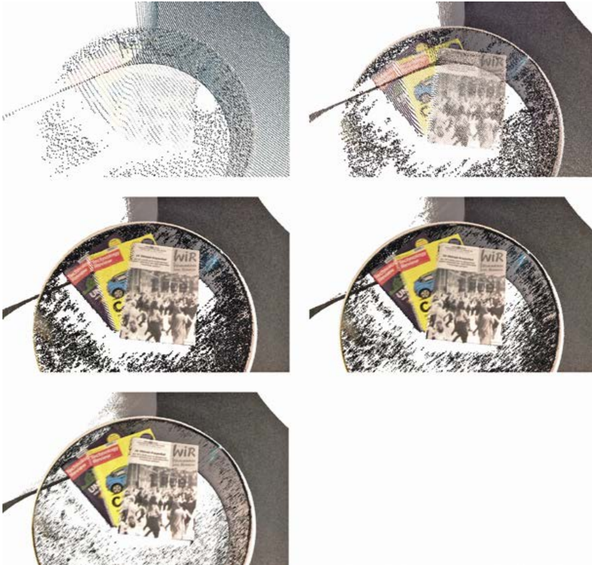
Abbildung 4.10: Vergleich verschiedener Auflösungen (in Klammern: Punktgröße der Ansicht): 1/20 (groß), 1/8 (groß), 1/4 (groß), 1/2 (mittel), 1/1 (klein).
