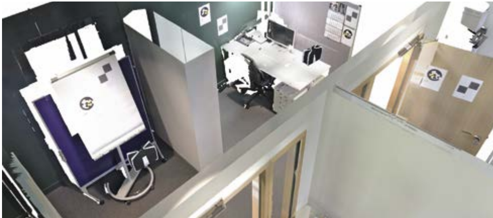
Abbildung 4.7: In der Punktwolke erkannte Zielmarken (gelbe Markierungen).
