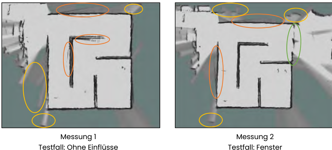
Abbildung 27: Erzeugte Umgebungskarten mittels der SLAM-Software Cartographer unter Verwendung des LiDAR-Sensors Slamtec RPLidar A2M8
