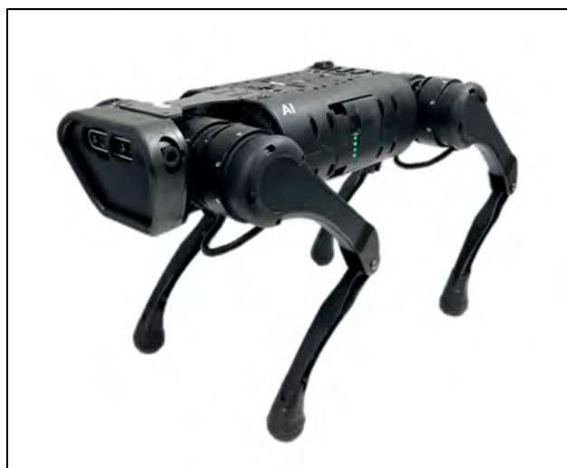
Abbildung 2: Vierbeiniger mobiler Roboter A1
