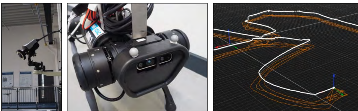
Abbildung 6: Bestandteile des Motion-Capture-Systems (Links: Fest installierte Infrarot-Kamera; Mitte: Marker auf Laufroboter; Rechts: Trajektorien der Marker)
