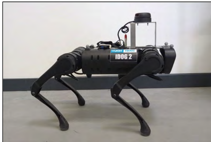
Abbildung 24: Aufbau vierbeiniger Laufroboter mit LiDAR-Sensor Slamtec RPLidar A2M8
