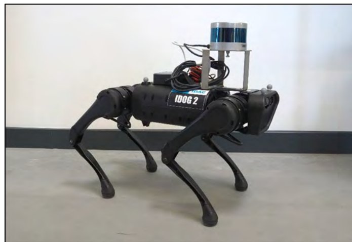
Abbildung 16: Aufbau vierbeiniger Laufroboter mit LiDAR-Sensor Velodyne Puck Lite
