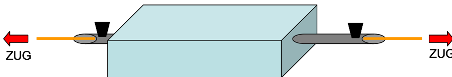
Herstellung einer Brückenbodenplatte mit Spannbeton (aus Wikipedia)
