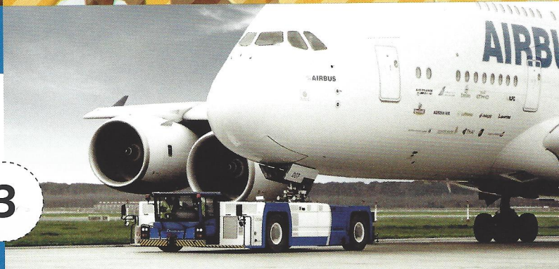
Die stangenlosen Flugzeugschlepper von Goldhofer nehmen die Bugräder der Flieger in einer speziellen Vorrichtung auf
