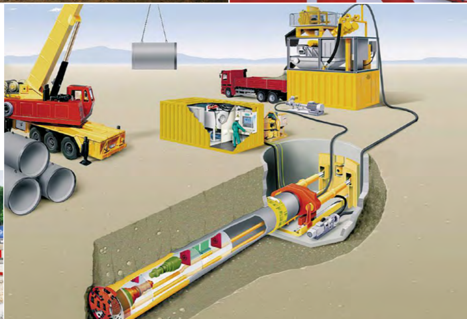
Oben links: Der Bohrkopf fräst altes Sielmauerwerk fort, um Platz für ein neues Rohr zu schaffen. Oben rechts: Die Vortriebsmaschine wird in den Bauschacht hinabgelassen, um dann auf Höhe des neu zu erstellenden Siels eingerichtet zu werden. Unten links: Ein Bohrschild neben dem einzubauenden Rohrstück. Unten rechts: Die gesamte Vortriebsapparatur mit Hydraulikanlage und Technik zur Ausspülung des Abraums.
