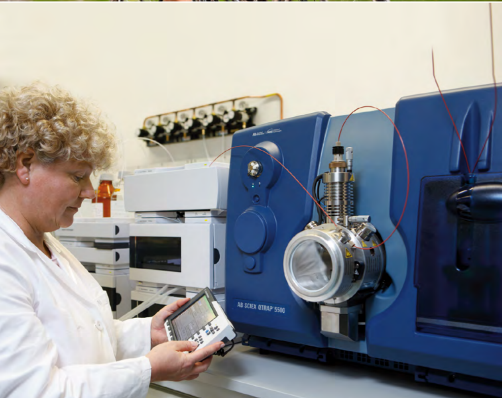
Oben: Probennehmer auf dem Weg vom Wasserwerk Billbrook zum Wasserlabor. Unten: Flüssigkeitschromatograph mit Massenspektrometrie-Kopplung zur Bestimmung von Pflanzenschutzmitteln, Arzneimitteln und deren Abbauprodukten im Wasser.
