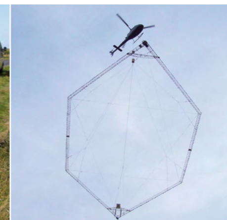
Elektromagnetische Verfahren zur Ermittlung der Tiefenlagen von Grundwasserleitern. Links: Messung mittels Bodenradar im Impulsreflexionsverfahren. Rechts: Bestimmung wasserführender Schichten aus der Luft mit dem Skytem-Verfahren, das Aufschlüsse über geologische Strukturen eiszeitlicher Rinnen bis in eine Tiefe von mehreren hundert Metern ermöglicht.
