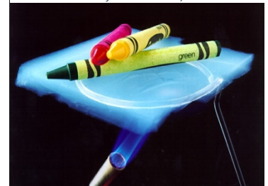
Bild 3: Die Aerogel-Platte isoliert so stark, dass die Wachsmalstifte über der Flamme nicht schmelzen. (Quelle: Courtesy NASA/JPL-Caltech – NASA Stardust Website, Lizenz: CC0 1.0)
