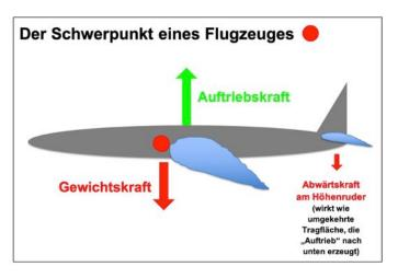
Fliegers und durch alles, womit er beladen ist. Sie zieht den Flieger nach unten. Wichtig bei einer Kraft ist der Punkt, an dem sie wirkt. Bei der Gewichtskraft nennt man diesen Punkt Schwerpunkt. Für einen waagerechten Flug muss die Auftriebskraft in der Nähe des Schwerpunktes wirken. Daher sollte der Schwerpunkt eines Flugzeuges etwa in der Mitte der Tragflächen liegen oder leicht davor.
