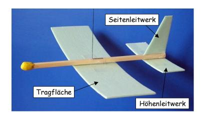
1. Lege die Tragfläche auf den Tisch. Bestimme die Mitte der großen Tragfläche. Lege eine Holzleiste auf diese Mittellinie, so dass sie vorn fast so viel wie hinten über die Tragfläche herausragt und klebe sie mit einem langen Tesafilmstück an der Tragfläche fest.
