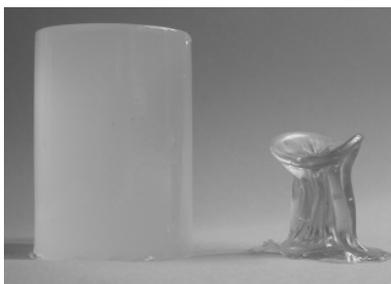
Bild 4: **Hydrogel** (links) und geschrumpftes **Hydrogel** nach Trocknung an der Luft (rechts)
