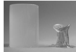
Bild 1: Hydrogel vor und nach einer "normalen" Trocknung
