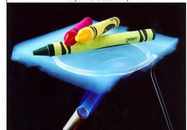
Bild 3: Die Aerogel-Platte isoliert so stark, dass die Wachsmalstifte über der Flamme nicht schmelzen. (Quelle: Courtesy NASA/JPL-Caltech – NASA Stardust Website, Lizenz: CCO 1.0)
