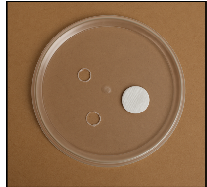
Bild 19: Ein Deckel mit Luftlöchern: Die Lust kann hinein, aber Filter halten andere Keime und Pilze draußen.
